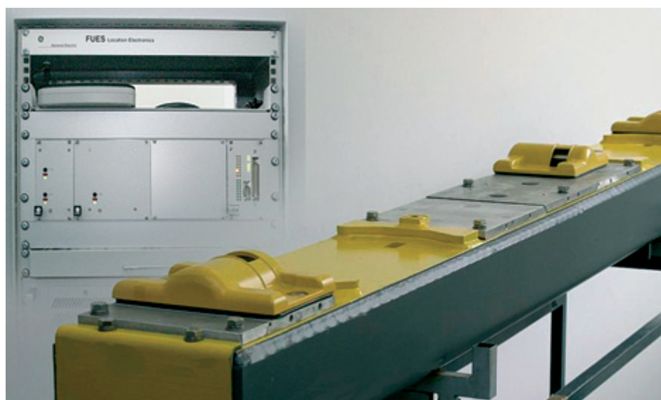
FÜS-Mess-Schwelle mit Steuerschrank
