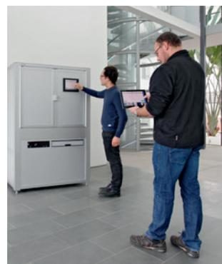
*Biegen und Krümmen – die Messmaschine MeSOMICS<sup>®</sup> ermittelt schnell und einfach Kabeleigenschaften, wie sie später auch im Fahrzeug auftreten. Die Messung läuft automatisch. Mitarbeitende spannen das Kabel lediglich ein und starten die Anlage.*
