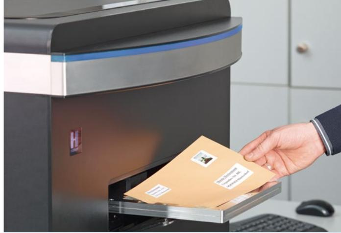
Die zu kontrollierende Sendung wird in das ausfahrbare Fach eingelegt und beim Einzug fotografiert.
