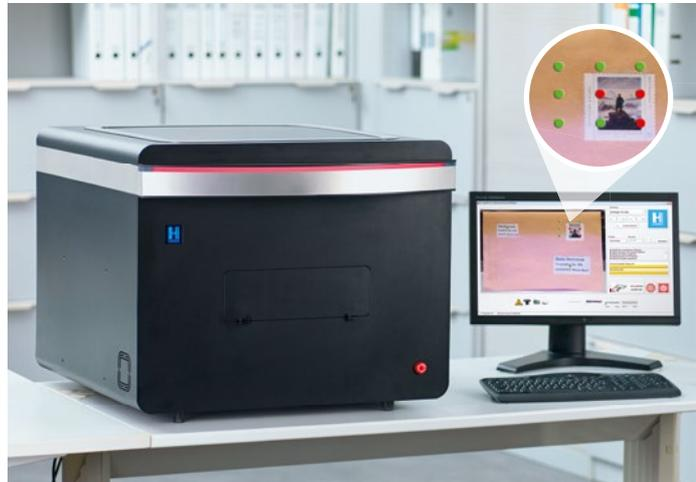
Identifiziert T-COGNITION 2.0 einen Gefahrenstoff, blinkt die rote Warnlampe. Die entsprechenden Messpunkte werden rot markiert.
