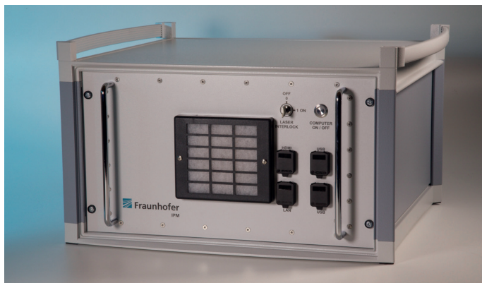
Abbildung 5: Fasergekoppeltes Terahertz-Messsystem, bestehend aus Basiseinheit und Messmodul. Die Basiseinheit enthält die zum Betrieb notwendige Optik und Elektronik sowie einen Rechner zur Systemsteuerung. Die Messmodule können individuell ausgelegt, hier für Reflexionsmessungen und auf einen XY-Scanner montiert.
